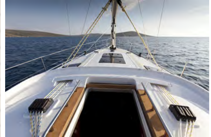
BAVARIA Doppel-Großschotsystem – ermöglicht genaues Trimmen ohne Traveller und sicheres Halsen.
