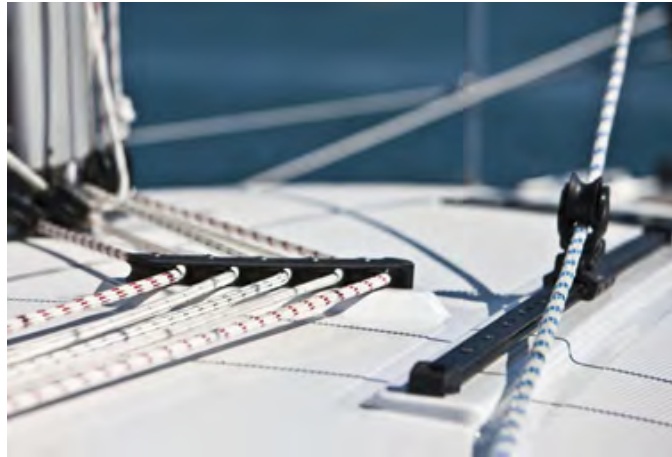
Die Genuaschienen auf dem Decksaufbau sorgen sowohl für ein aufgeräumtes Seitendeck als auch für hervorragende Am-Wind-Eigenschaften. The genoa tracks are positioned on top of the coachroof, ensuring uncluttered gangboards as well as excellent up-wind characteristics.
