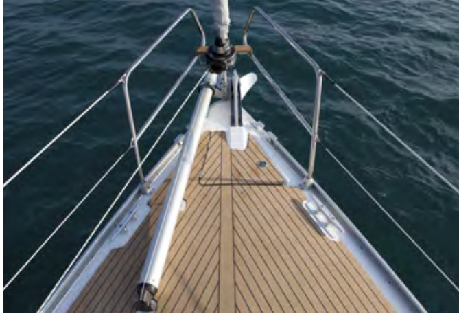
Ausfahrbarer und abnehmbarer Gennakerbaum*. Extendible and removable gennaker boom.*
