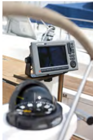
V ersenkbarer GPS Plotter im Cockpittisch*. The GPS chart plotter can be stored within the cockpit table.*
