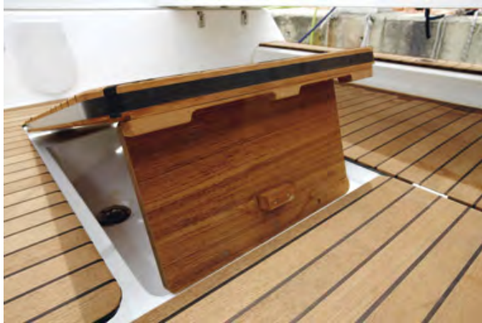
Perfekter Stand für den Steuermann durch ausklappbare Fußstützen (CR 45, 50 & 55).
