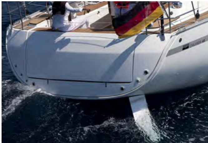
Doppelte Ruderblätter auf der CR 45, 50 und 55. Twin rudders with the CR 45, 50 und 55.
