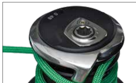
La poupée est traitée à l'anodisation dure aluminium. Ses facettes concaves permettent une accroche exceptionnelle.
