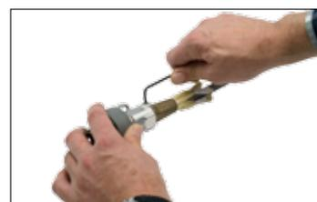
Installez le tambour et l'émerillon de drisse puis serrez la vis de blocage.
