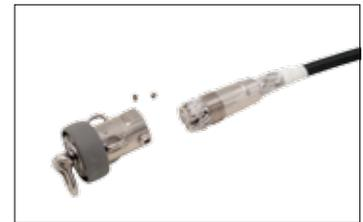
Tirez la terminaison sur le bout anti-torsion. Repliez la gaine du cordage au-dessus des ogives. Insérez les ogives dans la terminaison.
