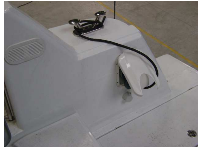
Prise de quai et disjoncteur 30mA
