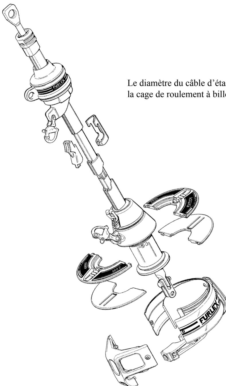
Le diamètre du câble d'étai est marqué sur la cage de roulement à billes (Réf. B21).
