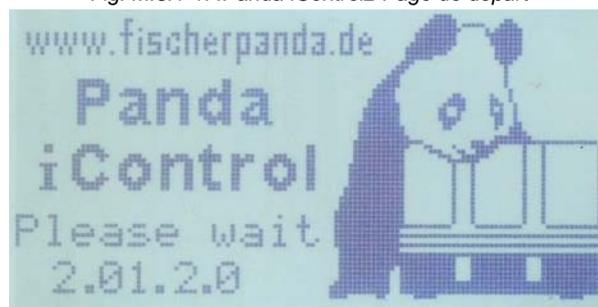
Fig. M.3.1-2: Version du matériel, type de générateur et version du logiciel sur l'écran standard
