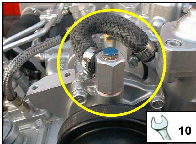
3. Ouvrez la vis de purge d'air sur le boîtier du thermostat. Refermez la vis dès que l'eau sort exempte de bulles d'air.
