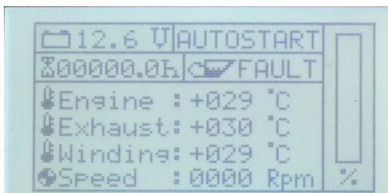
La fonctionnalité d'Autostart reste active même à la suite d'un arrêt et d'une remise en service de la commande par la touche On/Off. En vue de désactiver la fonctionnalité d'Autostart il faut enlever le fanion de l'EEPROM par "Disable" Siehe "Activation et désactivation de la fonctionnalité de démarrage automatique („Autostart“)" auf Seite 137.
