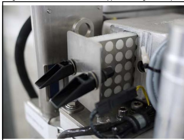
Remplacement de la masse filtrante.
