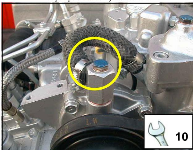
2. Desserrez la vis de purge d'air sur le boîtier du thermostat.
