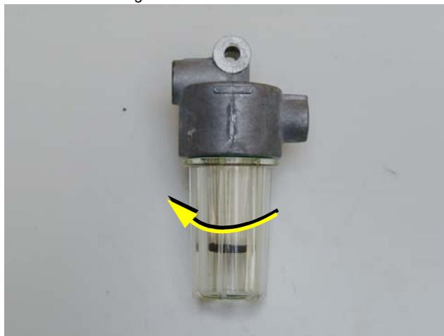
Dévissez l'élément filtrant pour le retirer du support.
