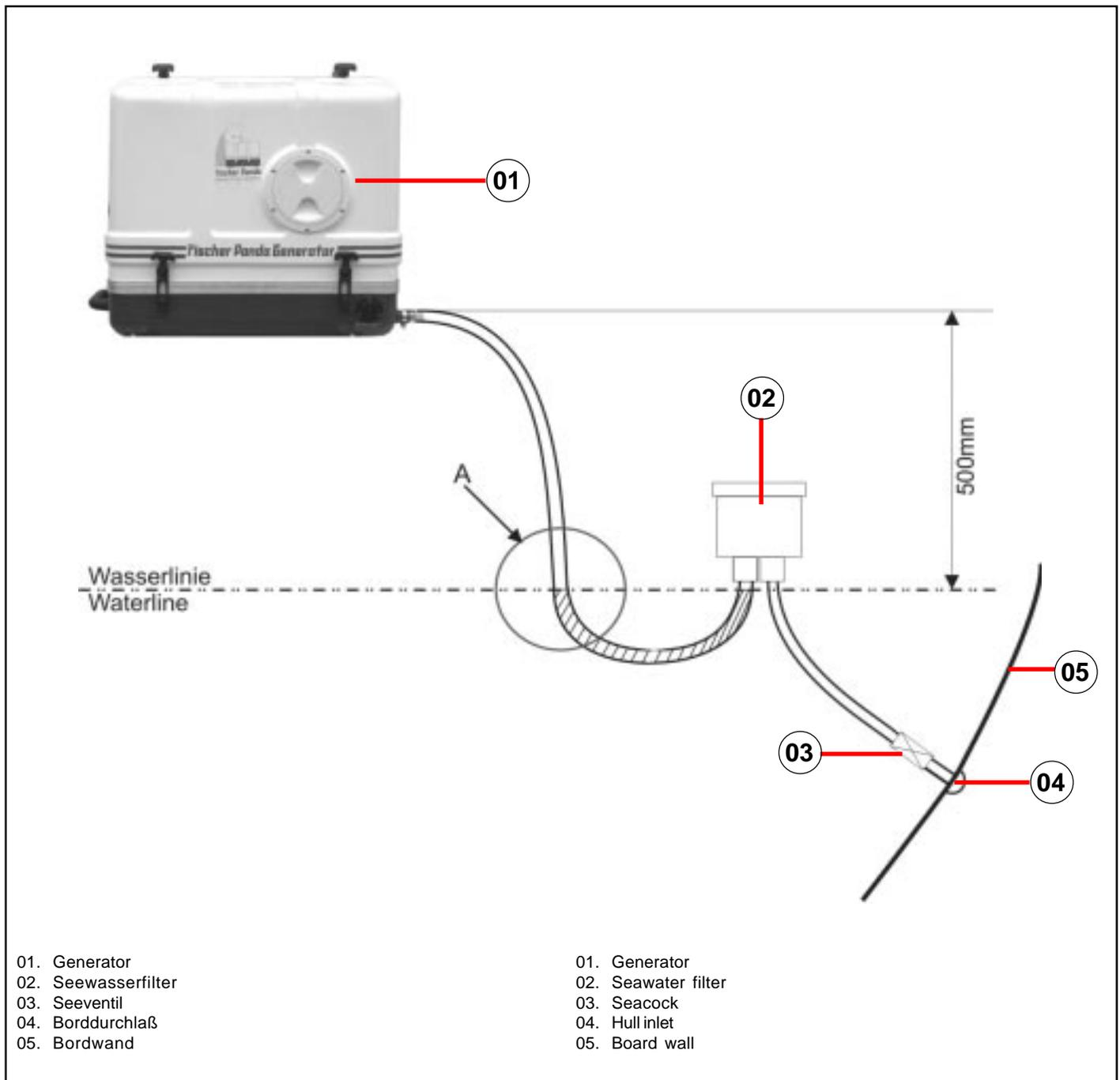
Durch die Installation eines Rückschlagventils in der Seewasser-Zulaufleitung, die sich unter der Wasserlinie befindet, kann dieses Problem ein wenig eingeschränkt werden.
