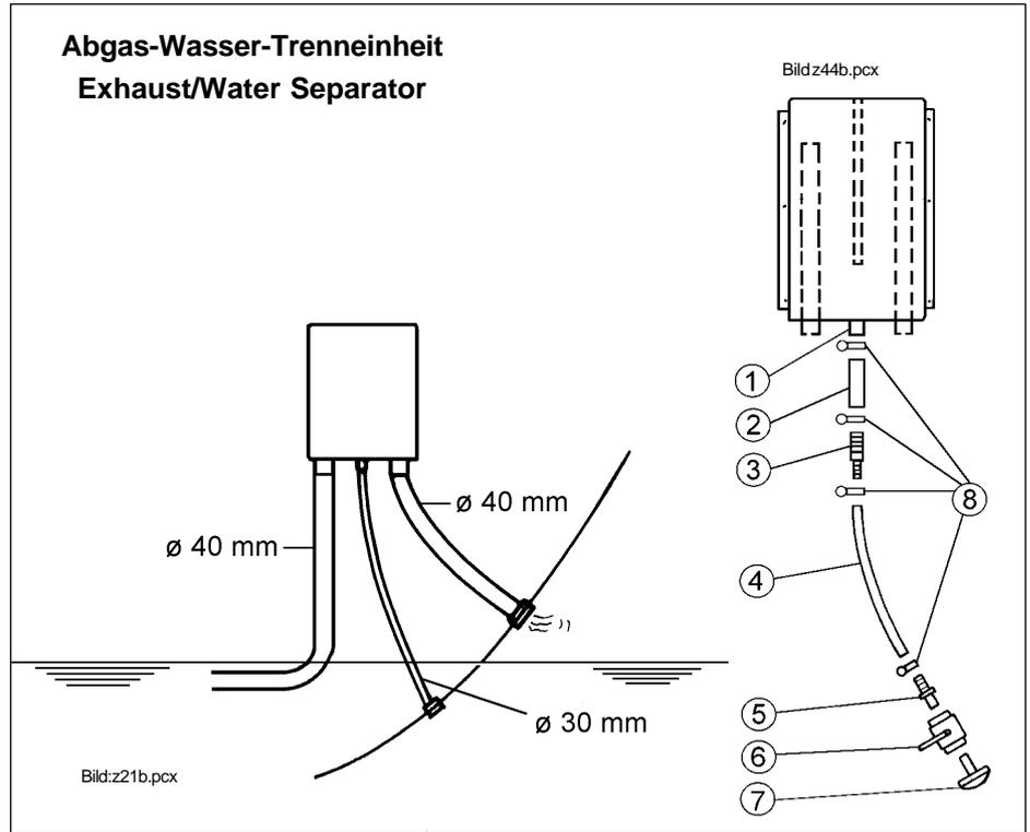
Der Wasserablauf an der Abgas-Wasser-Trenneinheit hat einen Durchmesser von 30mm. In vielen Fällen (bei kurzen Wegen) genügt es aber, wenn der Schlauch auf 1" (Innendurchmesser 25mm) reduziert wird.
