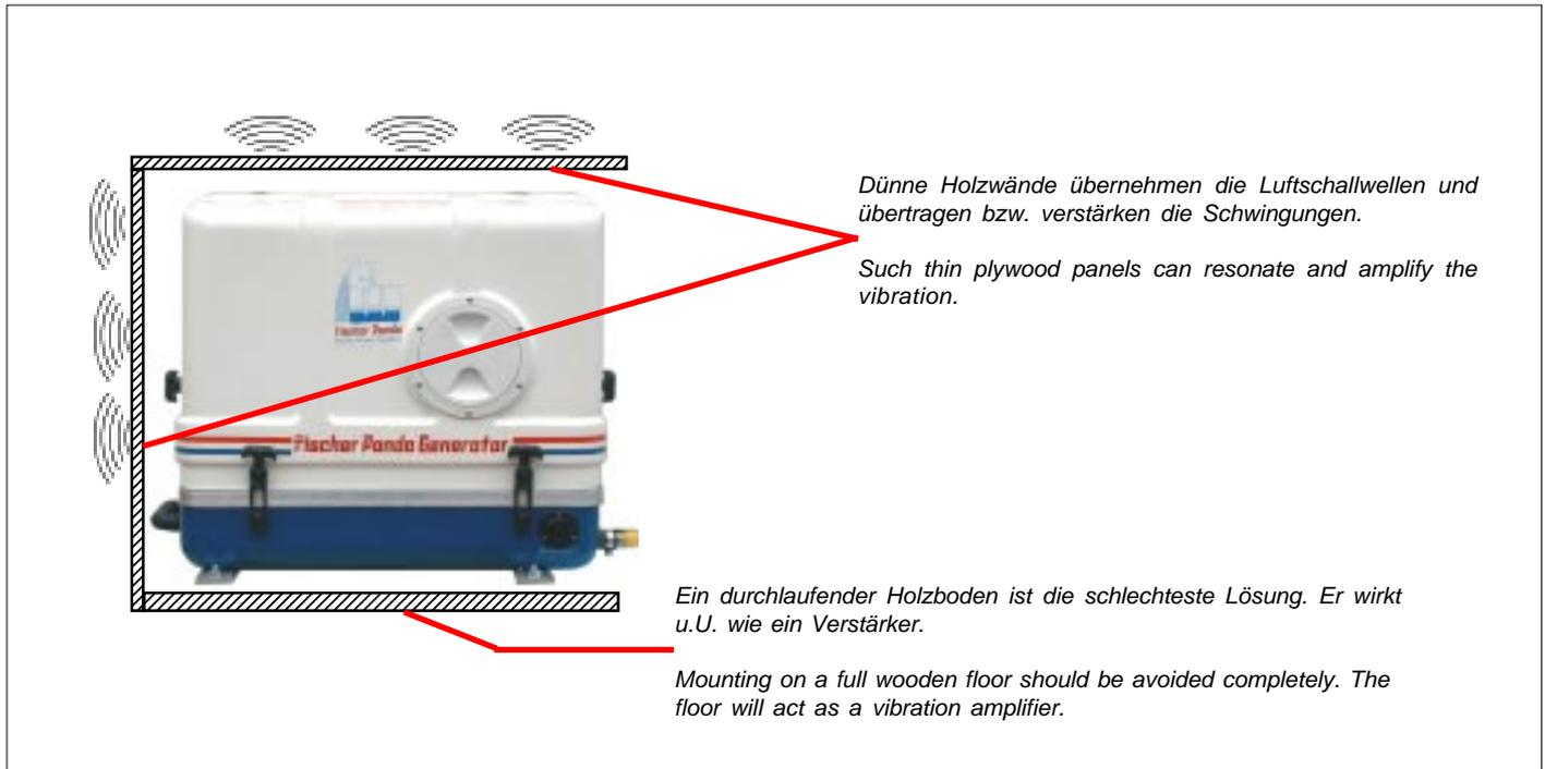
Es ist extrem schlecht, wenn der Generator auf einer glatten Fläche mit geringer Masse steht (z.B. Sperrholzplatte). Dies wirkt u.U. wie ein Verstärker auf die Luft-Schallwellen.
