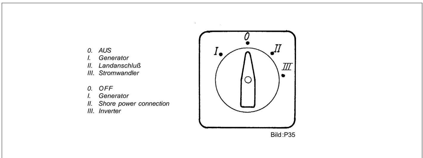
Wenn 3-Phasen-Drehstrom installiert wird und dieser Anschluß ebenfalls auch für Landstrom vorgesehen ist, muß hierfür ein **zusätzlicher** Trennschalter eingesetzt werden.
