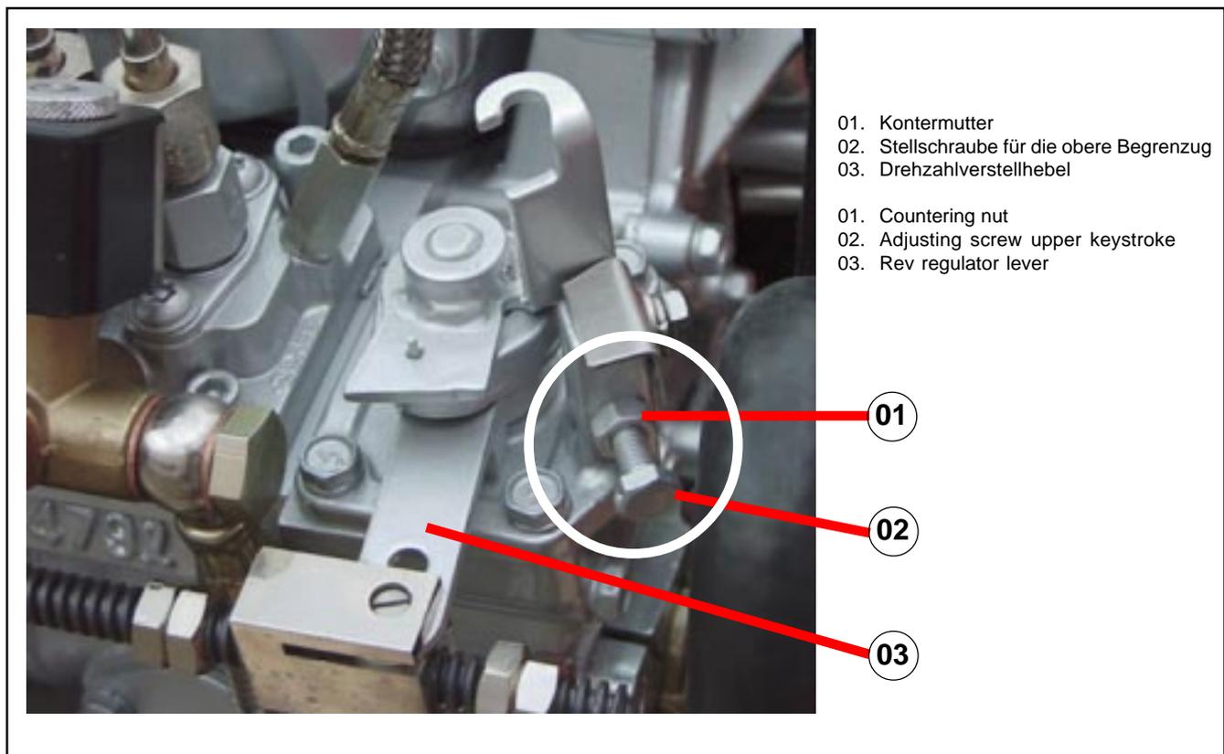
**B) Einstellung der normalen Begrenzung der Drehzahl durch die Stellmutter an der Drehzahlverstellspindel:**
