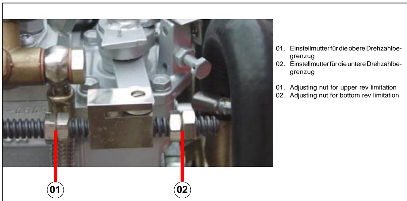
Wenn die Einstellung beendet ist, muss der elektrische Stecker zum Betrieb des Drehzahlstellmotors wieder eingesteckt werden.
