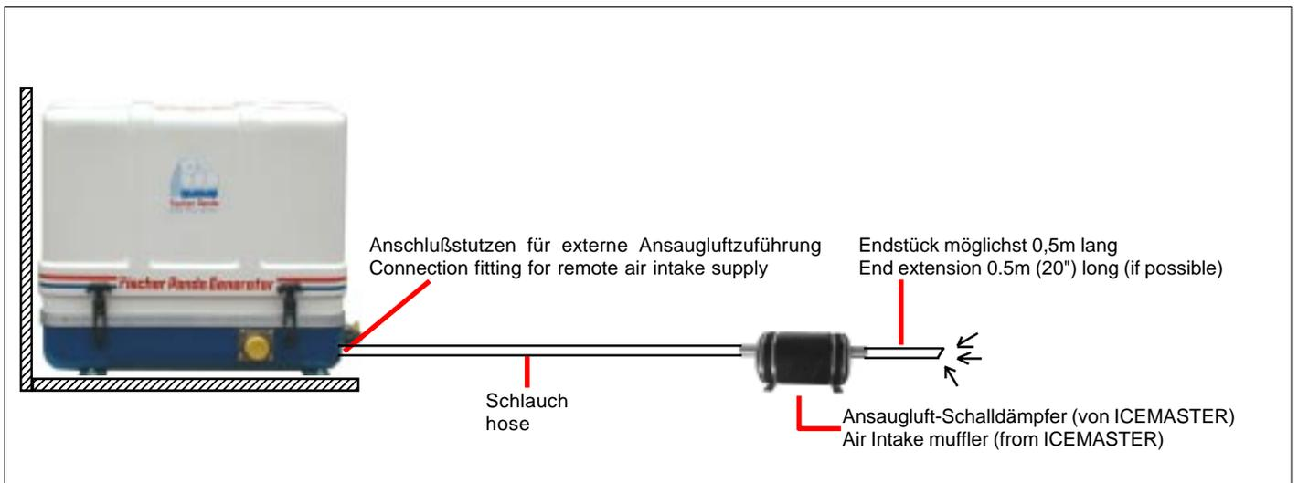
Wo immer es möglich ist, sollte eine separate Frischluftzuführung mit externem Ansaugluftschalldämpfer montiert werden. Dies kann das Geräuschverhalten erheblich verbessern.
