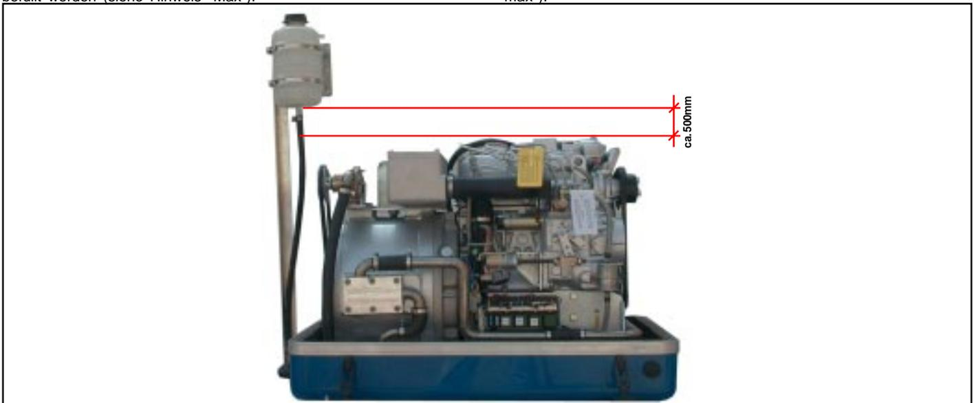
Sollten diese 500mm nicht eingehalten werden, d. h. der Kühlwasser-Ausgleichsbehälter wird niedriger montiert, können sehr große Probleme bei der Befüllung und der Entlüftung auftreten.
