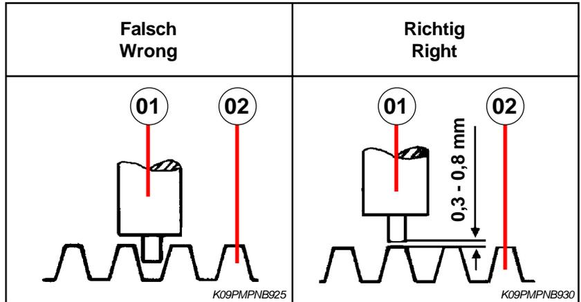
01. Drehzahlgeber mit Einschraubgewinde
