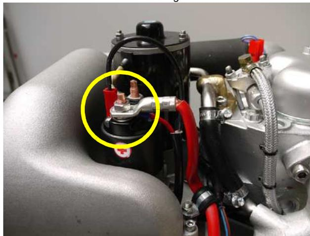
Fig. 5.6.1-2: Raccordement du câble (-) de la batterie de démarrage
