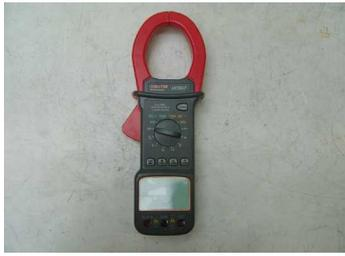
Pince ampérométrique (DC pour groupe électrogène synchrone; AC pour groupe électrogène asynchrone)
