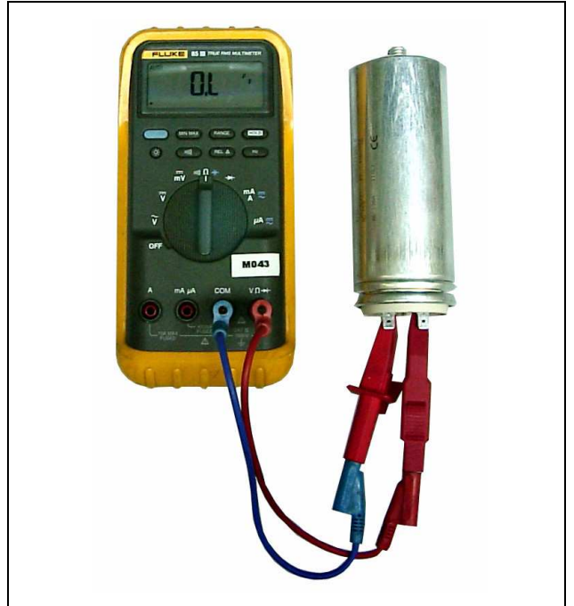
Fig. D.3.2-1: Checking the capacitor
