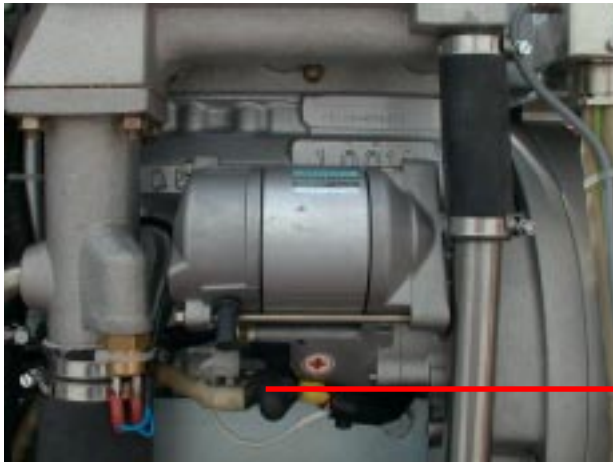
01. Anschluß Starterbatterie Pluskabel (+) 02. Anschluß Starterbatterie Minuskabel (-)
