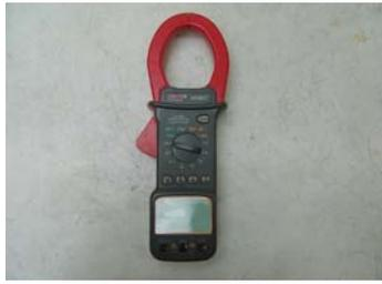
Pince ampérométrique (DC pour générateur synchrone; AC pour générateur asynchrone)
