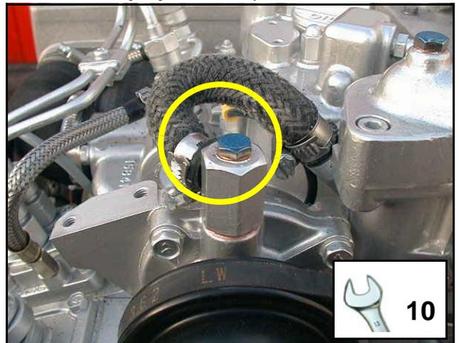
2. Desserrez la vis de purge d'air sur le boîtier du thermostat.
