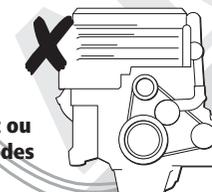
Pas de courbure brusque, de pincement ou de frottement sur les tubes.
