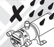
Ne pas installer dans le compartiment moteur, près des réservoirs à carburant ou dans un local susceptible de renfermer des vapeurs de carburant.
