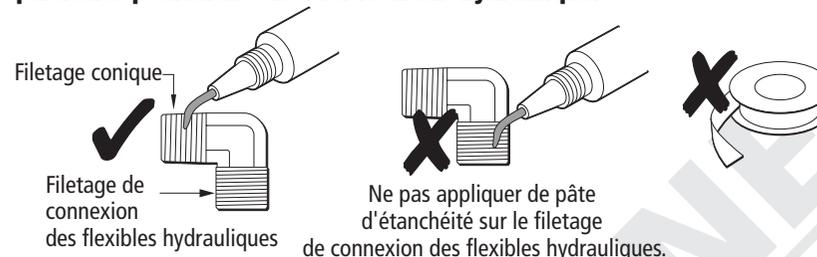
**Remarque :** Un enduit d'étanchéité est pré appliqué en usine sur le filetage conique des raccords hydrauliques fournis avec la pompe du pilote automatique. Appliquez un enduit d'étanchéité uniquement sur les joints supplémentaires que vous ajoutez au système. Le produit d'étanchéité recommandé est l'enduit Loctite 542.
