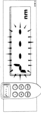
Cet affichage indique que le pilote, lorsqu'il est en mode TRACK ne reçoit pas le message du positionneur.
