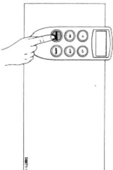
2. Sélectionner le niveau d'illumination 3 sur les instruments ou sur le boîtier de commande du pilote.
