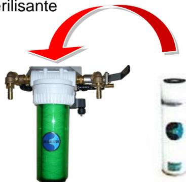
10. Tourner la vanne de rinçage vers eau douce sous pression en laissant un peu de stérilisant dans la cartouche.
