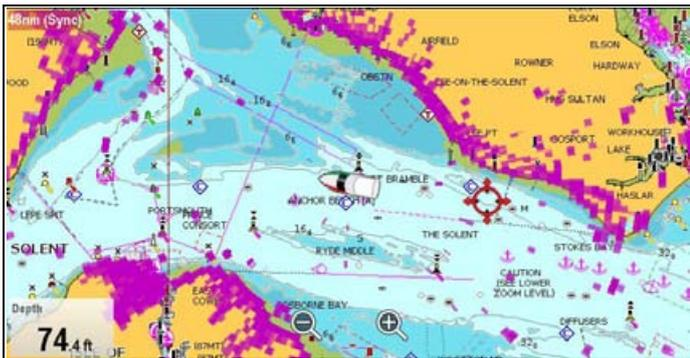
**Note :** Pour utiliser la fonction de superposition radar, vous devez utiliser une source extérieure pour le cap magnétique (p. ex. un compas Fluxgate). Vous ne pouvez pas utiliser les données COG pour la superposition radar.
