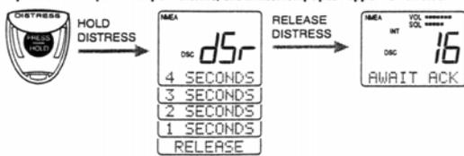
4. Lors de la réception d'une réponse, l'indicateur DSC clignote et l'alarme de détresse ASN retentit. L'écran LCD déroule un message signalant l'accusé de réception, ainsi que le numéro MMSI de la station qui a émis l'accusé de réception. Le message et l'alarme sont renouvelés jusqu'à ce que vous appuyiez sur la touche CLR.
