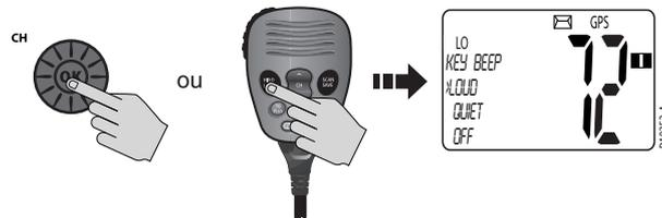
6. Tournez le bouton **CH/OK** de l'émetteur-récepteur ou appuyez sur les touches ▲/▼ du microphone pour mettre en surbrillance l'option désirée.
