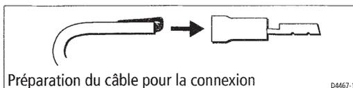
fils dénudés ne dépassent de l'arrière de l'isolant de la cosse.
