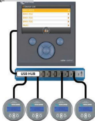
Au maximum, quatre BMV peuvent être connectés directement au Color Control. Davantage de BMV peuvent être connectés à un Hub USB pour un contrôle central.
