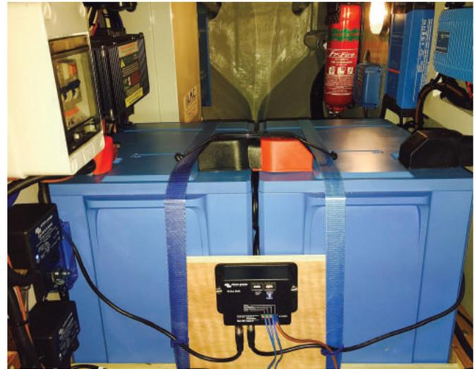
Associés à une connexion Internet, il n'y a aucune raison de s'inquiéter de l'état de charge (SoC) de la batterie, puisque vous pouvez laisser votre bateau n'importe où et contrôler le système à distance à l'aide d'un Smartphone ou d'un ordinateur portable. C'est ce que l'on appelle la « Console à distance », dont un exemple est montré ci-dessous.
