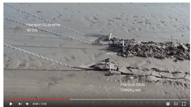
Test des ancrs Mantus Anchors, Rocna et Manson Supreme tirées par un poids-lourd
