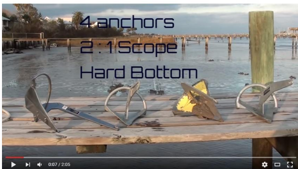
Test des ancrs Mantus Anchors, Manson Supreme, Rocna et Spade
