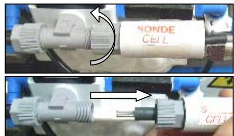
**NB :** Ne pas rapprocher les broches de la sonde sous risque de détériorer le salinomètre ou d'altérer la mesure.
