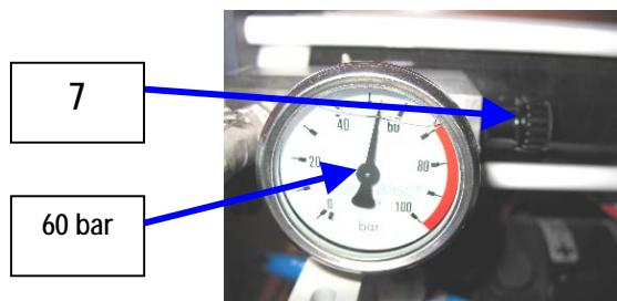
5. Después de algunos minutos, comprobar que la desalinizadora **AQUA-BASE** funciona correctamente, que produce bien y que el agua producida es de buena calidad (LED verde se encendie)
