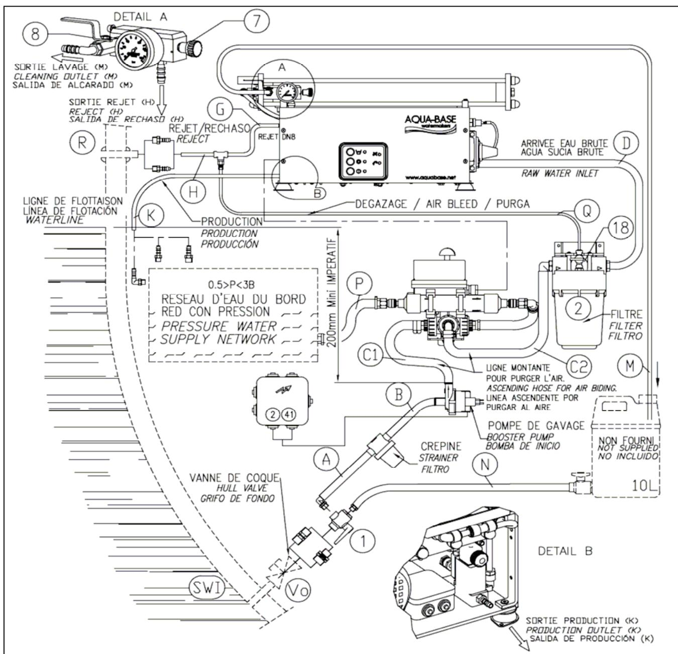
**MONTAGE POMPE DE GAVAGE & KIT DE SEPARATION / ASSEMBLING BOOSTER PUMP & SEPARATION KIT / MONTAJE BOMBA BP Y KIT DE SEPARACIÓN**
