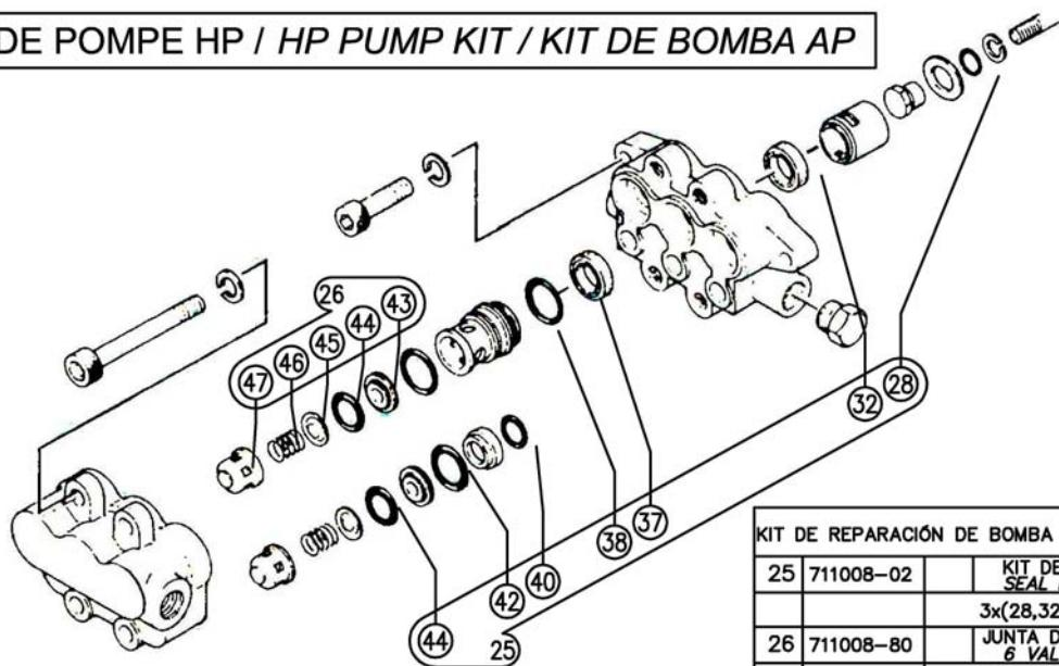
**KIT DE REPARACIÓN DE BOMBA AP / HP PUMP REPAIR KIT**
