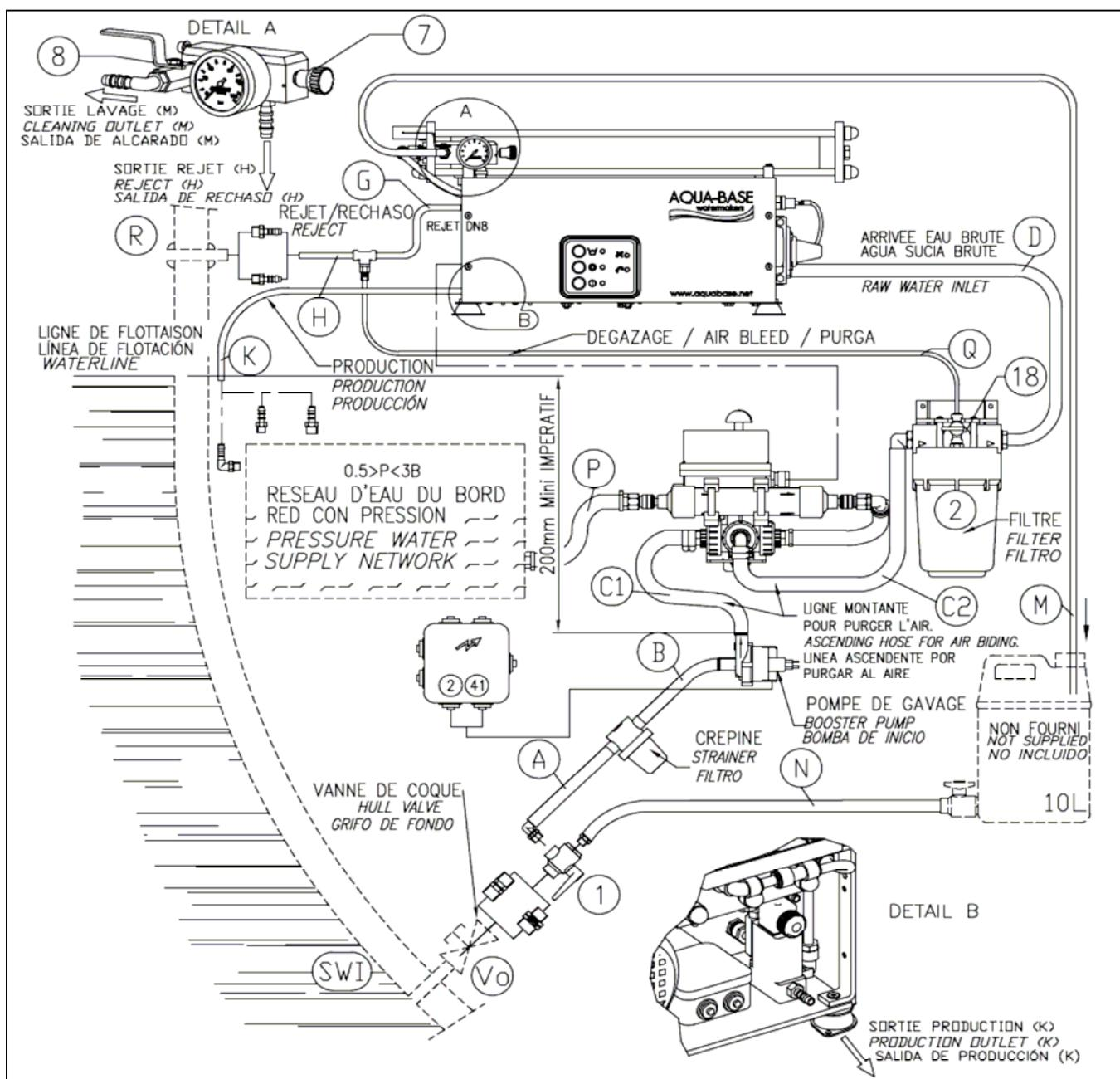
**MONTAGE POMPE DE GAVAGE & KIT DE SEPARATION / ASSEMBLING BOOSTER PUMP & SEPARATION KIT
