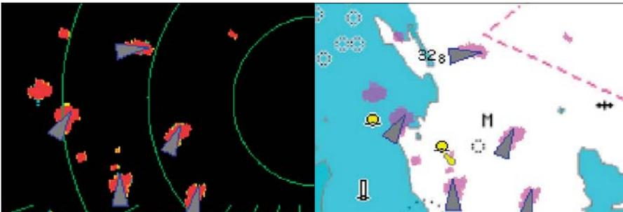
Superposition des cibles AIS sur l'écran radar (à gauche) et sur l'affichage cartographique (à droite)
