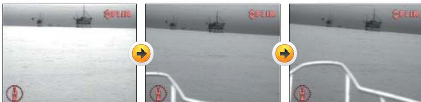
Imageur gyrostabilisé, cible toujours à l'écran malgré le tangage de l'étrave
