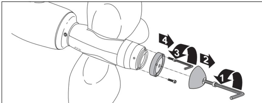
1 - enlever l'anode (opération 1, clef ALLEN Type B) et le support en bronze (opération 3, clef ALLEN Type C) voir tableau 1.
