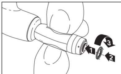
9 - monter la bague de blocage encore une fois.
