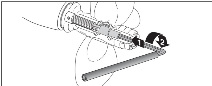
8 - Enduire le filetage de l'arbre de liquide type "frein filet" ; repositionner l'hélice sur l'arbre en alignant le logement de la vis de sécurité avec le trou créé puis visser la vis principale à l'aide de la clef ALLEN type A. Serrer fortement à l'aide d'un tube rallonge de longueur 20 à 30 cm.
