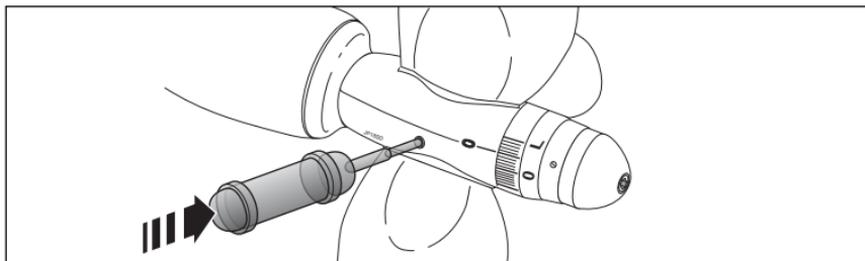
2 - pomper de la graisse marine immergeable dans l'hélice ( nous conseillons le Type Tecnolube Polimar 400 ) au moyen du graisseur spécial
