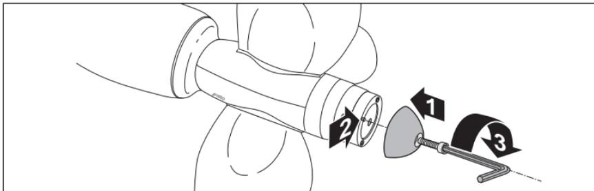
2 - Fixer la nouvelle anode en faisant attention à introduire le grain de ferme ( opération 2 ) dans le logement spécial sur le zinc.
