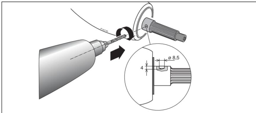
7 - A l'aide d'un foret de  $\varnothing 8,5$  mm percer (sur l'empreinte créée) un trou de 4 mm de profondeur.
