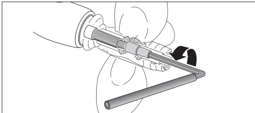
4 - introduire la clef ALEN Type A dans l'écrou et dévisser (sens anti-horaire) avec l'aide d'un tube métallique de longueur 20/30 cm.
