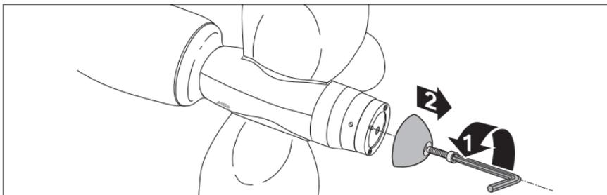
1 - enlever la vieille anode ( clef Type B, tableau 1, section 2)
