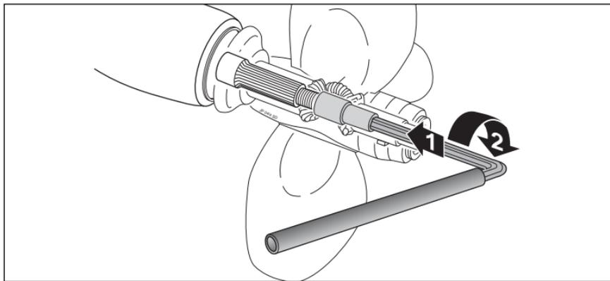
4 - visser l'écrou de l'hélice avec la clef ALEN Type A, en serrant fort avec l'aide d'un tube métallique d'une longueur de 20/30 cm.
