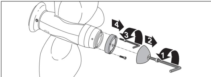
1 - enlever l'anode en zinc ( operation 1, clef ALLEN Type B) et le support en bronze ( operation 3, clef ALLEN Type C) voir tableau 1 - section 2.
