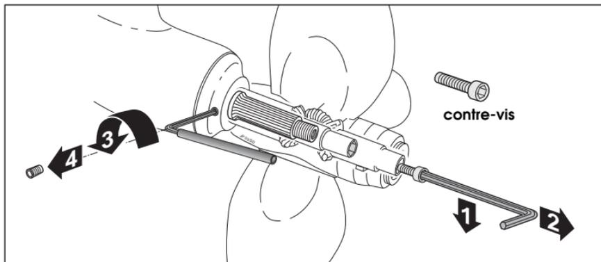
3 - incliner la clef ALEN et extraire la contre-vis. Insérer la clef ALEN type D dans la vis de sécurité, dévisser (sens anti-horaire) à l'aide d'une rallonge métallique de longueur 15-20 cm et extraire la vis.
