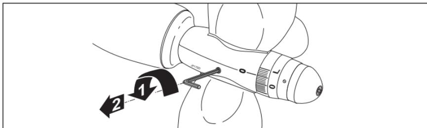
1 - dévisser le grain (vis ALLEN) situé sous le point rouge (clef Type C, tableau 1, section 2).
