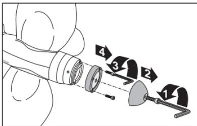
1 - enlever l'anode en zinc et le support en bronze avec la clef ALEN Type B pour l'opération A et Type C pour l'opération 3 ( voyer tableau 1- section 2).
