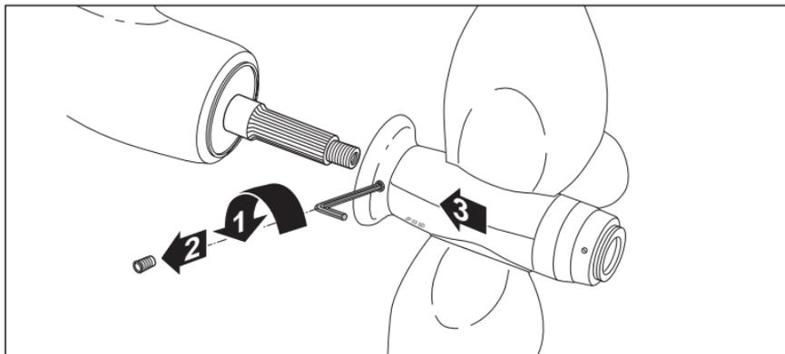
3 - Enlevez la vis ALEN de sécurité a l'aide de la clefs ALEN type et installer l'hélice sur l'arbre
