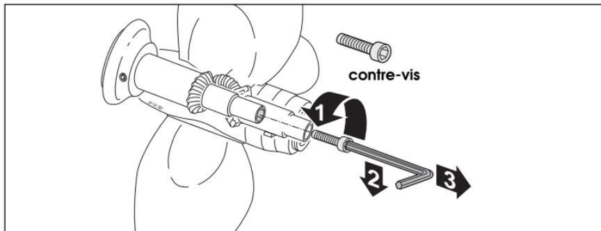
2 - introduire la clef ALLEN Type B dans la contre-vis et la dévisser (sens anti-horaire) jusqu'à ce qu'il soit complètement libre. Inclinez la clef ALLEN et retirez le contre-vis.
